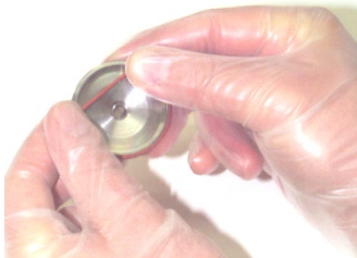
Bild 3a O-Ring einsetzen
